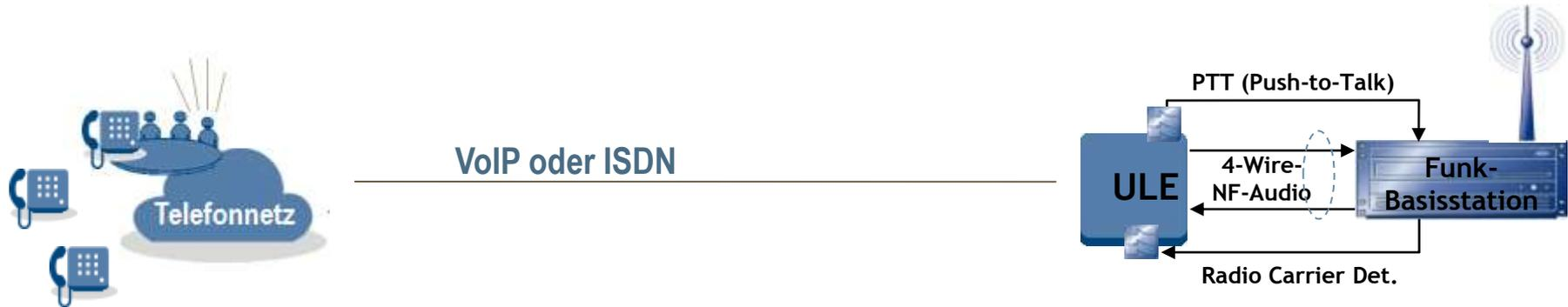
ULE als Gateway zur Anbindung von Funk-Basisstationen mit analogen Schnittstellen für die Sprachübertragung (ggf. auch Lautsprecherausgang und Mikrofon-Eingang des Funkgerätes). Die automatische Einwahl in eine Konferenzschiene erlaubt den blockadefreien Zugang zum Funksprechverkehr von verschiedenen Telefon-Endgeräten aus.
