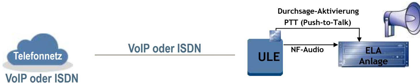
ULE als Gateway zur Anbindung von elektroakustischen Anlagen (ELA), Sprachalarmanlagen (SAA) oder elektroakustischen Notfallwarnsystemen (ENS) mit analogen Schnittstellen für die Sprachübertragung (ggf. auch Lautsprecherausgang und Mikrofon-Eingang der Anlage).
