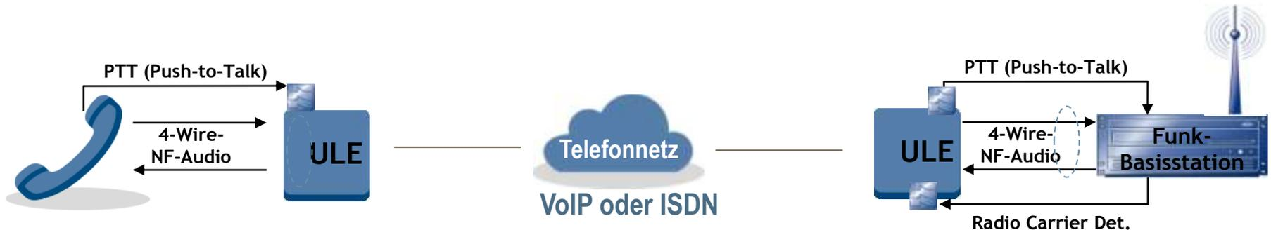
Zwei ULE (jeweils eine auf jeder Seite einer Übertragungsstrecke) übertragen analoge Signale (Sprache etc.) zwischen Geräten/Systemen mit analoger Schnittstelle über digitale Verbindungsnetze wie auf einer Standleitung.
